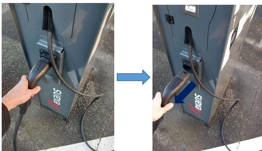
**D**ébranchez ensuite le câble au niveau du capot avant du véhicule électrique Mouv'nGo et rangez-le dans le coffre.
