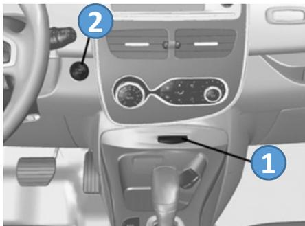
Insérez la Clé du véhicule dans le lecteur ① (pour information le levier de position de vitesse ③ est en position P (Parking/Arrêt)).
